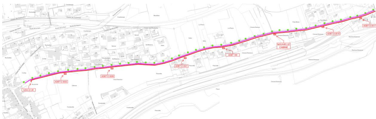
Extrait Schéma Eli10 – Implantation des mâts d'éclairage (points verts)
