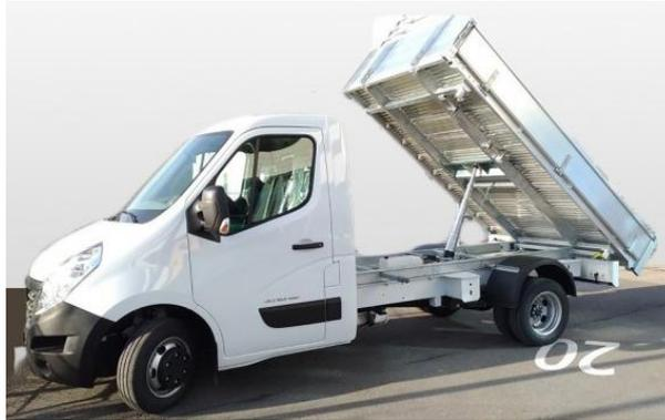
*Exemple d'un véhicule utilitaire avec pont basculant*
